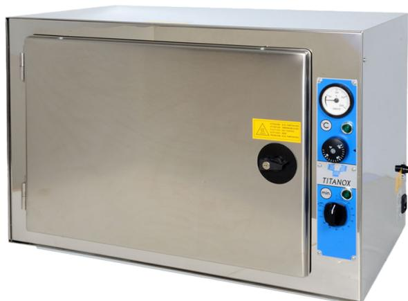
STERILIZZATORI AD ARIA CALDA TITANOX • Unità: Standard • Capacità: 60 litri • Misure esterne (mm): 705x450xh 475 • Misure interne (mm): 535x320xh 345 Struttura interna e ripiani regolabili in altezza interamente in acciaio inox. Chiusura a chiave. Unità standard: doppia resistenza per raggiungere più rapidamente temperature elevate. Tutti i modelli sono forniti con manuale in: GB, FR, IT (ES su richiesta) e 2 vassoi regolabili in altezza. Made in Italy.
