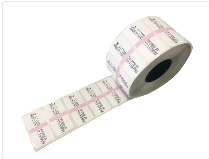
ETICHETTA VAPORE 2 LINEE - conf. da 12.000 (24 rotoli da 500 etichette) La prima linea di stampa può visualizzare: 3 caratteri alfabetici + 11 numeri La seconda linea di stampa può visualizzare: 14 numeri Etichetta indicatore di vapore, idonea per ciclo di sterilizzazione a vapore. Doppio supporto adesivo. Dopo il ciclo di sterilizzazione, l'indicatore passa dal ROSA originario al MARRONE. Indicatore di processo: Standard Vapore ISO Classe 1, inchiostro non tossico, senza lattice.
