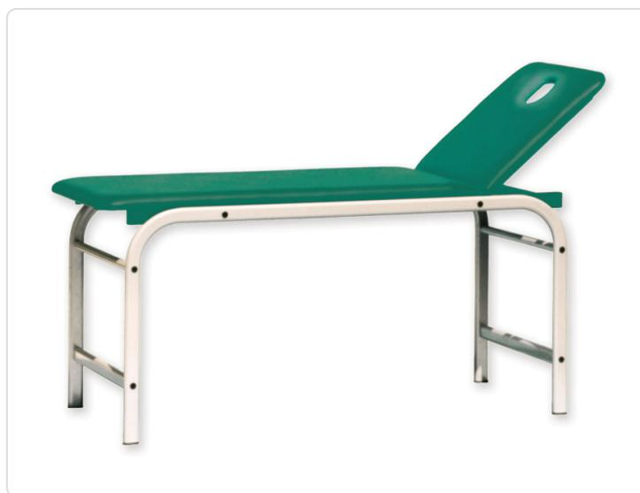
Struttura in tubo ovale robusta ed elegante 50 x 25 mm, verniciata con polveri epossidiche colore grigio metallizzato. Rivestimento lavabile, ignifugo, materiale similpelle classe 1 IM con imbottitura ad alta densità. Testata regolabile tramite sistema meccanico (massimo 75°).
