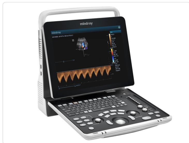
ECOGRAFO PORTATILE A COLORI MINDRAY Z50 con display LCD ad alta risoluzione 15", 2 connettori sonda, hard disk 500GB, 4 porte USB, pacchetto software, multipli, senza sonde.
