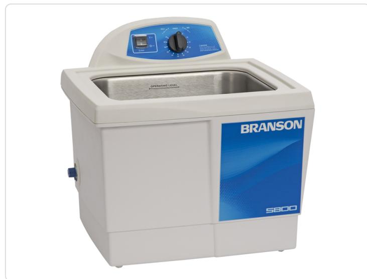
Serie MH (temporizzatore meccanico con riscaldamento): comprende un temporizzatore meccanico con scala di regolazione fino a 60 minuti e un sistema di riscaldamento.\_
