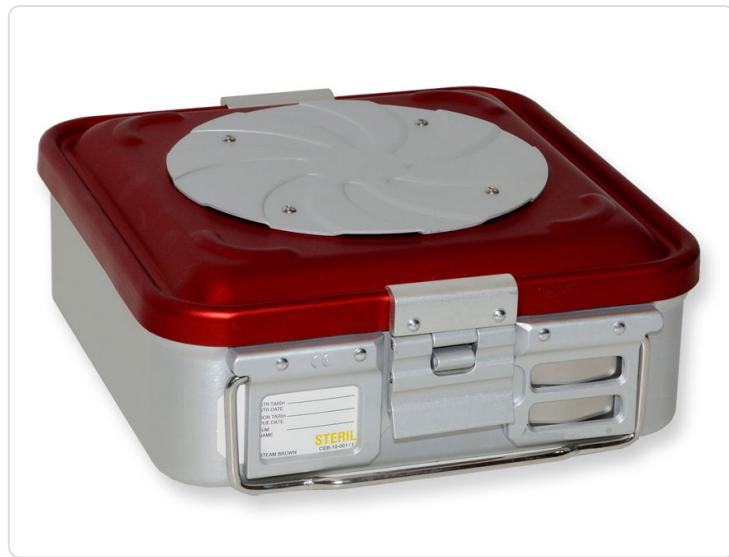
Container "BARRIER SYSTEM" con valvola e fondo non perforato. Il "Barrier System" è preferibile quando è richiesto un uso continuo dei container, evitando la sostituzione del filtro. La valvola si apre durante la sterilizzazione per permettere l'uscita del vapore.
