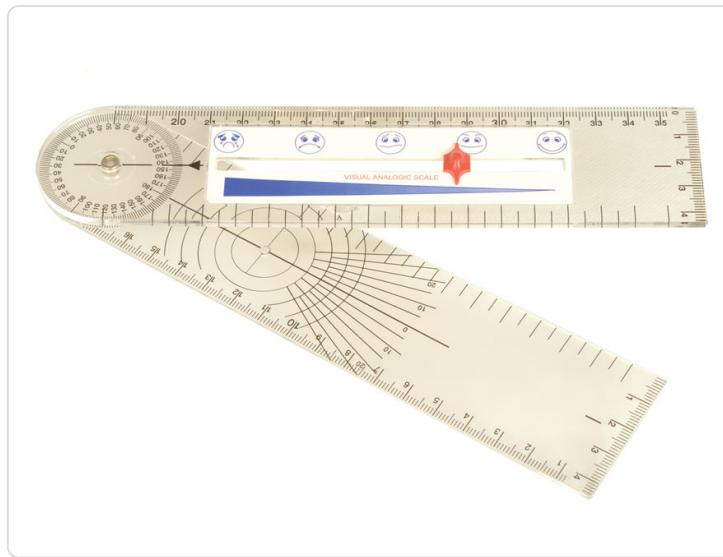
GONIOMETRO CON SCALA PER LA MISURAZIONE DELLA SOGLIA DEL DOLORE - 203x45x7 mm
