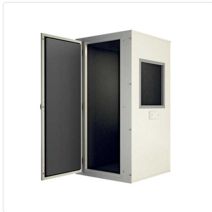
NEW PRO 25 - 96x96x197 cm Cabina mobile, leggera, insonorizzata, facile da installare in pochi minuti. Interni in poliuretano fonoassorbente rivestito con materiale per isolamento acustico lavabile e igienizzabile. Esterno composto da pannelli resistenti, ignifughi e lavabili. Modulo per connessione cavo incluso. Made in Italy. Porta ad apertura a scelta (destra/sinistra) con chiusura magnetica.
