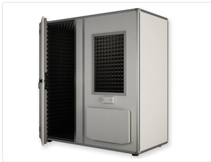
PRO 30 - 211x107x244 cm - L'altezza comprende il sistema di ventilazione (27 cm) Interni in espanso piramidale acustico autoestinguente grigio antracite. Gamma con varie misure, caratterizzata da un'elevata riduzione del rumore e sistema di ventilazione. Esterno composto da pannelli resistenti, ignifughi e lavabili e telaio in alluminio. Modulo per connessione cavo incluso. Su richiesta, sistema igienizzante di ricambio aria. Made in Italy.
