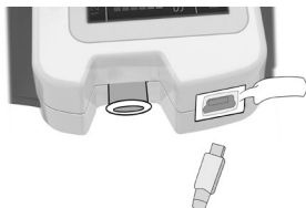
Figura 5.16 Schema di collegamento tra il misuratore dell'apnea notturna e il cavo USB
