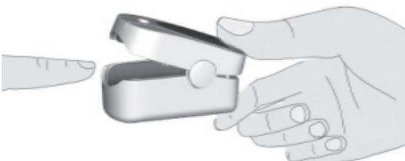
C. Il dispositivo si accende automaticamente dopo 2 secondi e inizia la misurazione.
